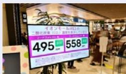
館内のCO<sub>2</sub>濃度を測定。良好な室内空気環境を維持するための換気量が確保できているかを表示しています。
