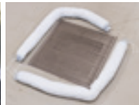
万一の事故に備えてチューブ型油吸収材を常備
