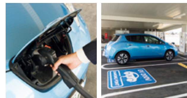
EV充電器をつないでいる様子
