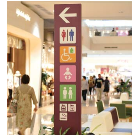
専門家を交えて色、大きさ、数量、配置の検証を重ね、見やすさを追求したサイン。2011年3月にオープンしたイオンモール大牟田では、ピクトサインを従来の250mm角から320mm角へ変更し、視認性をさらに高めています。
