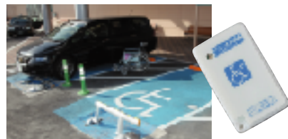
リモコンで駐車スペースのバーの開閉ができる。
