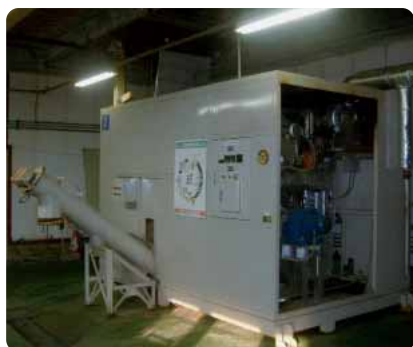
成田SCの縁の下のか持ち 生ごみコンポストの再資源化設備
