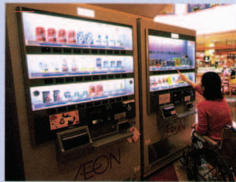
バリアフリーの自動販売機の設置 ボタンや取出口の位置が工夫され、誰もが簡単に使えるように改善されています
